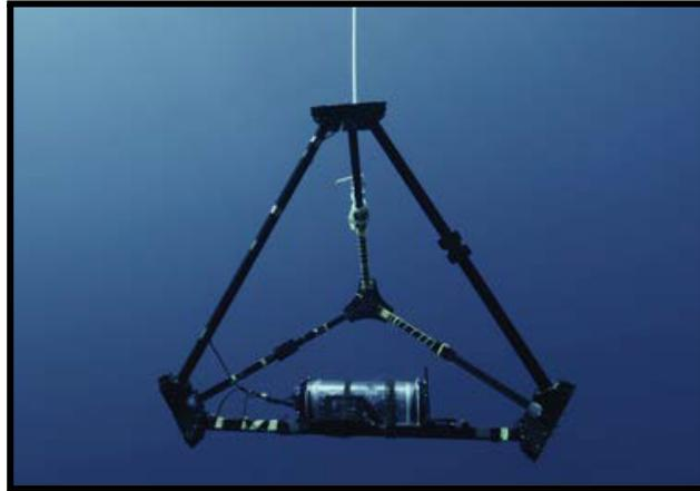
Figure 3.2 : Antenne tétra en immersion par -20 m lors de la mission WhaleWay. Design V. Gies et H. Glotin. Sa version 'penta' intègre un 5<sup>ème</sup> hydrophone (crédit F. Sarano / Longitude 181).
