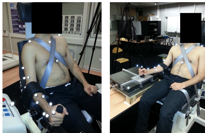
Figure 34 : Dispositif expérimental de mesure des couples articulaires maximaux isométriques sur Biodex (à gauche). Dispositif expérimental de mesure des forces maximales isométrique sur plate-forme de force
